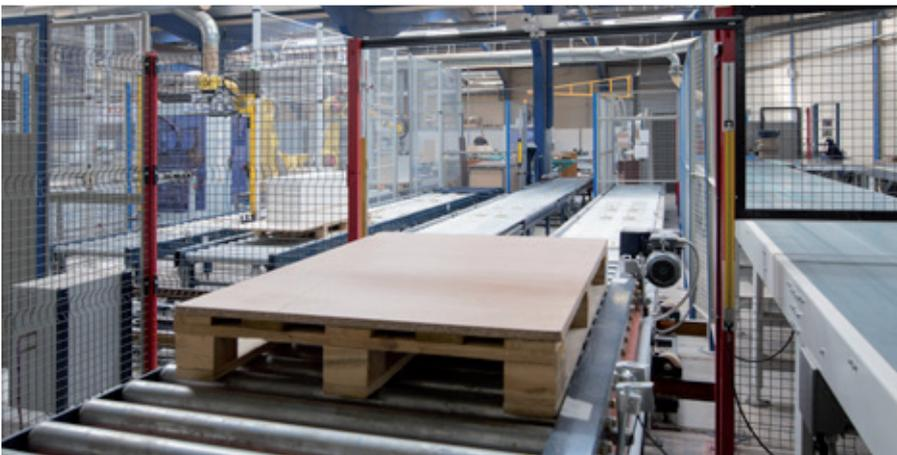
Mecalux ha instalado un avanzado circuito de transportadores en el centro de producción de Euréquip, empresa francesa fabricante de muebles. Su misión es trasladar la mercancía a través de los distintos procesos que transforman los paneles de madera empleados para la posterior fabricación de los muebles. Este sistema de transporte confiere mucha agilidad en el traslado de la mercancía hacia las posiciones requeridas por la operativa.
