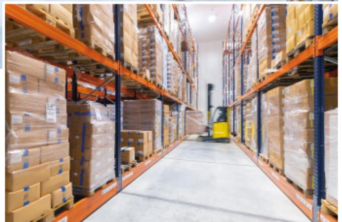
La cámara de congelación de Sabarot en Chaspuzac (Francia) cuenta con estanterías sobre bases móviles Movirack de Mecalux de 9,5 m de altura. Esta solución aprovecha al máximo toda la superficie disponible con el propósito lograr una mayor capacidad de almacenaje y reduce el consumo de energía para generar frío. En total, se pueden depositar 1.816 palets con todos los productos terminados.
